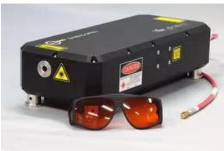
Sagittar-L 系列Sagittar-L 低重频高脉冲能量的全固态皮秒激光器具有体积小、光束质量好、稳定性高等优点，逐渐受到远程高精度人造卫星测距系统的青睐。测距用千赫兹 Sagittar-L 系列固体激光器具有较高的且稳定的脉冲能量，优质的光束质量，极小的光束发散角，是远程高精度测距等应用方向的一个理想选择。
